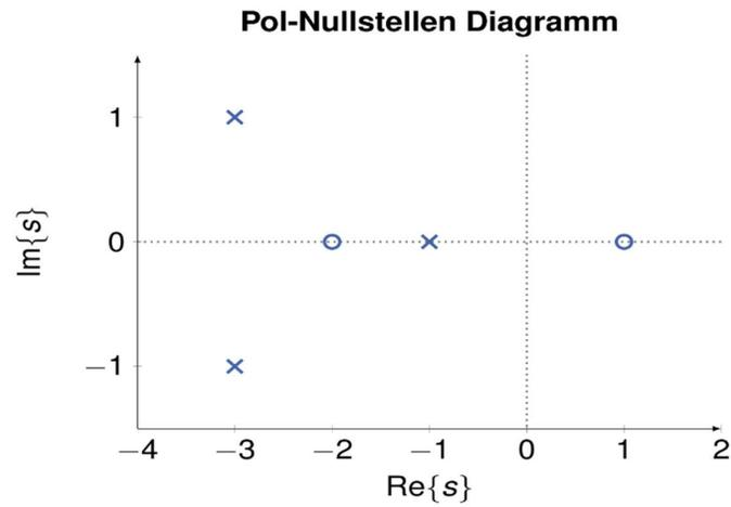
Wie lautet die Pol-Nullstellen-Diagramms? *Abbildung 4: Pol-Nullstellendiagramm eines unbekannten Systems  $G(s)$*
