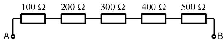
Zwischen den Klemmen A und B liegt die Spannung  $U_{AB} = 500 \text{ V}$ .
