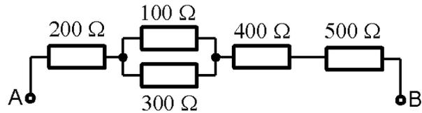
Zwischen den Klemmen A und B liegt die Spannung  $U_{AB} = 1000 \text{ V}$ .
